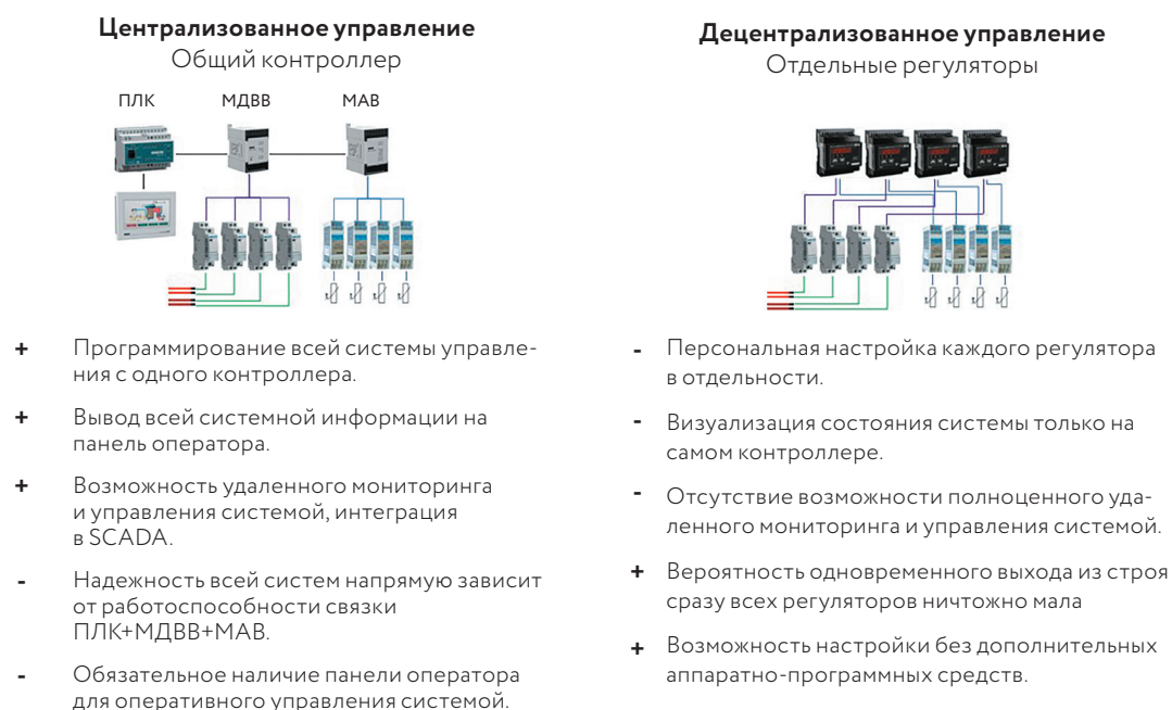
Рис. 1. Сравнение разных концепций систем управления ПЛК – промышленный логический контроллер, МДВВ – модуль дискретных входов и выходов, МАВ – модуль аналогового ввода.
