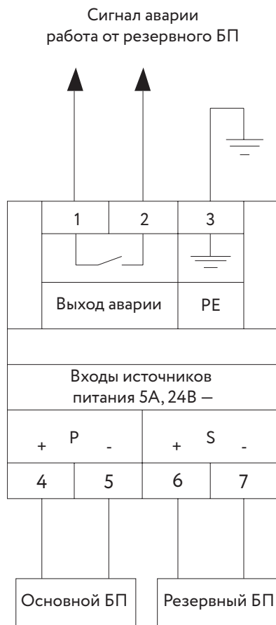
Рис. 13 Схема подключения модуля IPS к блокам питания
