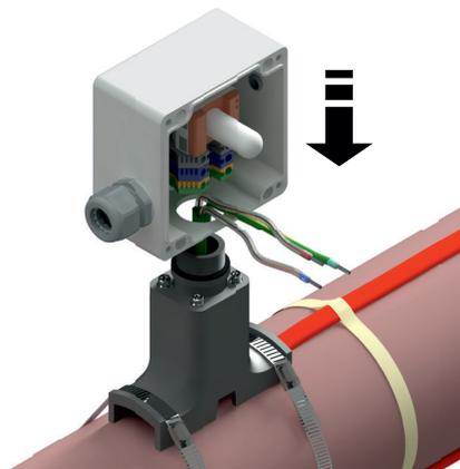
**Шаг 12:** Зафиксируйте корпус коробки на опоре с помощью гайки ДЭСТУ.0002 (поз.7). Гайка закручивается с помощью ключа для круглых шлицевых гаек под внешний диаметр гайки от 45 мм до 52 мм (ключ в комплект поставки не входит).
