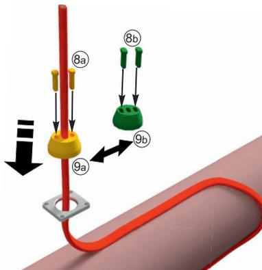
**Шаг 5:** Наденьте на нагревательные секции опору УВК.01.01 (Поз. 5) и протяните кабель вверх. Вставьте уплотнение в опору.
