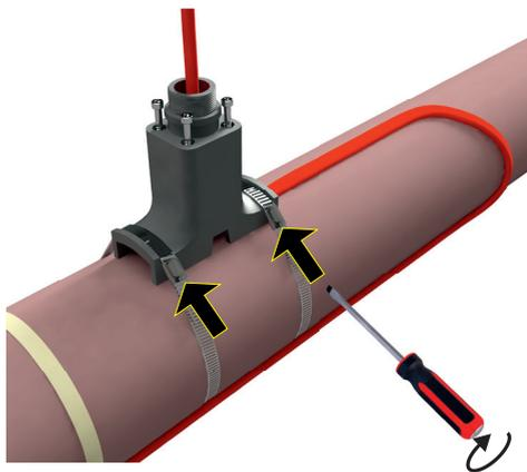
**Шаг 8:** После того, как на нагревательные секции будут установлены комплекты заделок (в соответствии с руководством по эксплуатации на выбранный комплект заделок), сверху на опору наденьте кольцо прямого сечения (Поз. 6).
