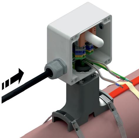
**Шаг 14:** Подключите силовой кабель и провод заземления к клеммным соединителям. Выполните подключение нагревательных секций и соедините с клеммами заземления оплетки нагревательного кабеля. Соедините лепесток болта заземления и клемму заземления перемычкой (поз.13).
