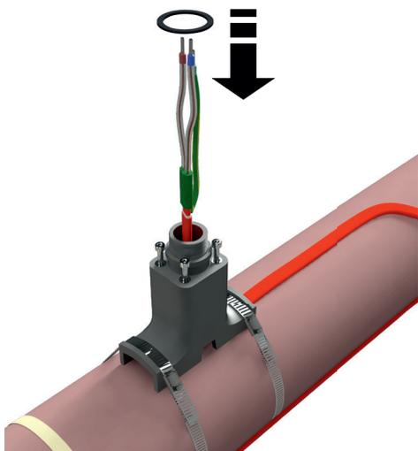
**Шаг 9:** Излишек кабеля протяните обратно через опору (А) в сторону обогреваемого объекта. Закрепите излишек кабеля с помощью адгезивной крепежной ленты FT/НТМ (В). Затяните крепежные винты на опоре (С) с усилием, достаточным для выполнения герметизации нагревательной секции в опоре.
