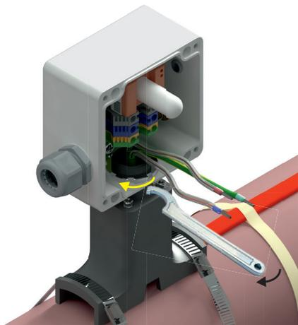
**Шаг 13:** Через кабельный ввод введите силовой кабель на достаточную длину для выполнения подключения к клеммным соединителям.
