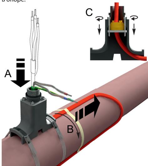
**Шаг 10:** Установите кабельные вводы и заглушки из комплекта поставки соединительной коробки в отверстия в соответствии с моделью коробки и ее назначением. Внутри кабельных вводов установите уплотнения и затяните гайки кабельных вводов.
