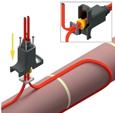
**3 нагревательных кабеля:** заведите 3 нагревательных кабеля в пластину УВК.0012 и в опору – через уплотнение. Заглушки при этом не используются. Установите соединительную коробку в соответствии с Шагами 7–17 вышеизложенной инструкции по монтажу.
