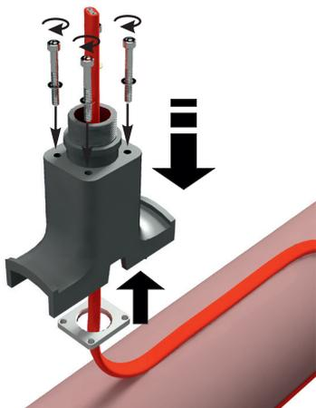
**Шаг 7:** Установите опору на трубопровод и закрепите ее с помощью хомутов PFS / 3 (Поз. 14) таким образом, чтобы хомуты не пережимали нагревательную секцию.
