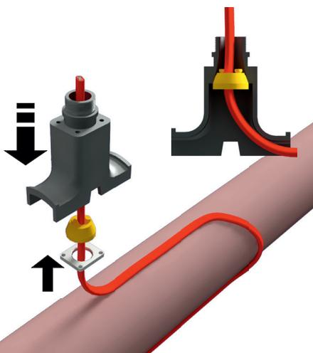
**Шаг 6:** Вставьте в опору сверху четыре винта крепежа уплотнения (размер под ключ 4 мм) с шайбами и наживите их в пластину с помощью ключа-шестигранника (в комплект поставки не входит). Не затягивайте винты до конца. Это нужно будет сделать на заключительном этапе монтажа.
